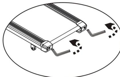
Поверните против часовой стрелки, чтобы уменьшить натяжение
